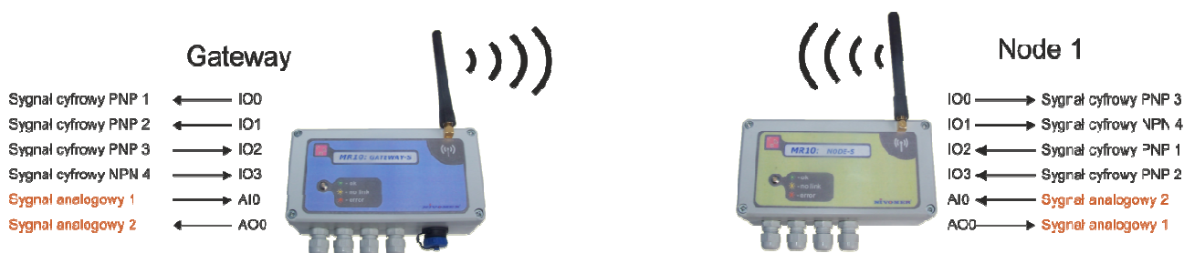
Rys. 1 System MR10 składający się z modemu Gateway i Node.
