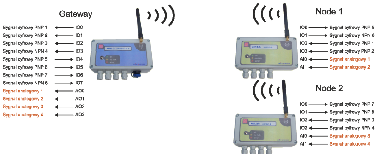
Rys 2. System MR10 składający się z modemu Gateway i wielu Nodów
